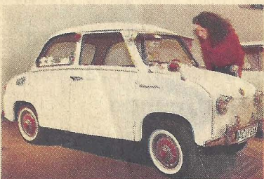
Gogomobil , zwei Zylinder, 13,6 PS und 72 km/h schnell.
